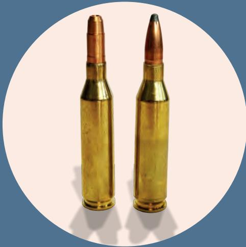
Calibre 243, version mono-métallique (à droite) et balle demi-blindée classique pointe plomb (à gauche).
